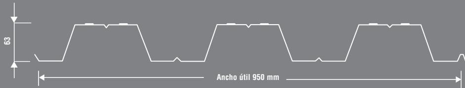
**Especificaciones Técnicas** Panel de acero de 3 montes que permite, en conjunto con hormigón estructural, la construcción de losas colaborantes.
